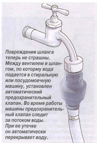
Вентиль для подключения автоматических стиральных и посудомоечных машин имеет клапан, предотвращающий возврат воды в водопровод и вантуз.
